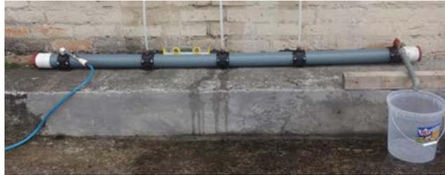
**Figura 6. Permeámetro construido para la valoración de la conductividad de la grava**
