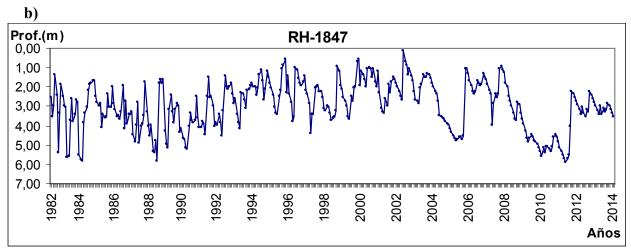
Figura 3 (a,b). Comportamiento de los niveles de las aguas subterráneas aguas arriba del humedal
