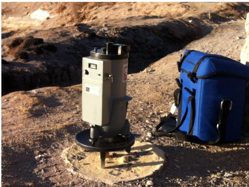
Figura 3-7. Fotografía del gravímetro utilizado durante los trabajos de la campaña de geofísica gravimétrica en la cuenca del Río Loa en Septiembre del 2012 Fuente: elaboración propia.
