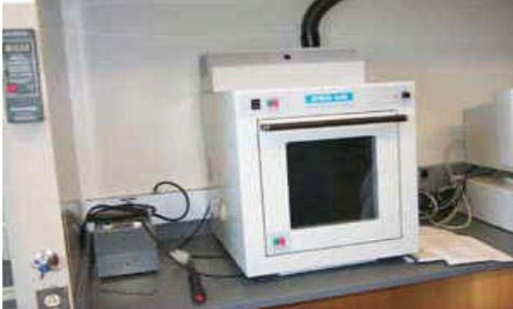
**Imagen 4.** Equipo de Purificación de agua, para obtener agua Suprapur, libre de iones y minerales.
