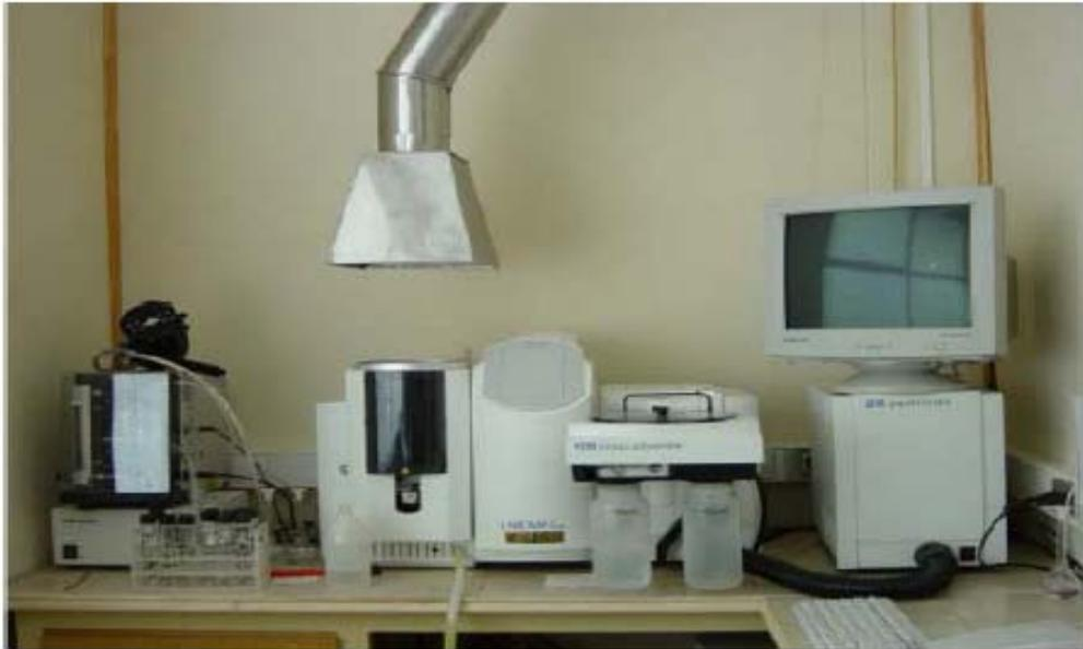
**Imagen 2.** Equipo de Espectrofotometría de Absorción Atómica **Perkin Elmer**, modelo 3110.
