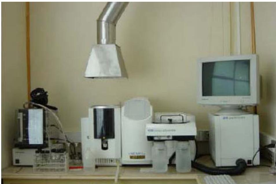
**Imagen 2.** Espectrofotómetro de Absorción Atómica, Perkin Elmer, modelo 3110 y un generador de Hidruro.
