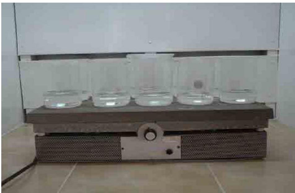
**Imagen 5.** Placa Térmica, utilizada para realizar la digestión ácida de los Sedimento.
