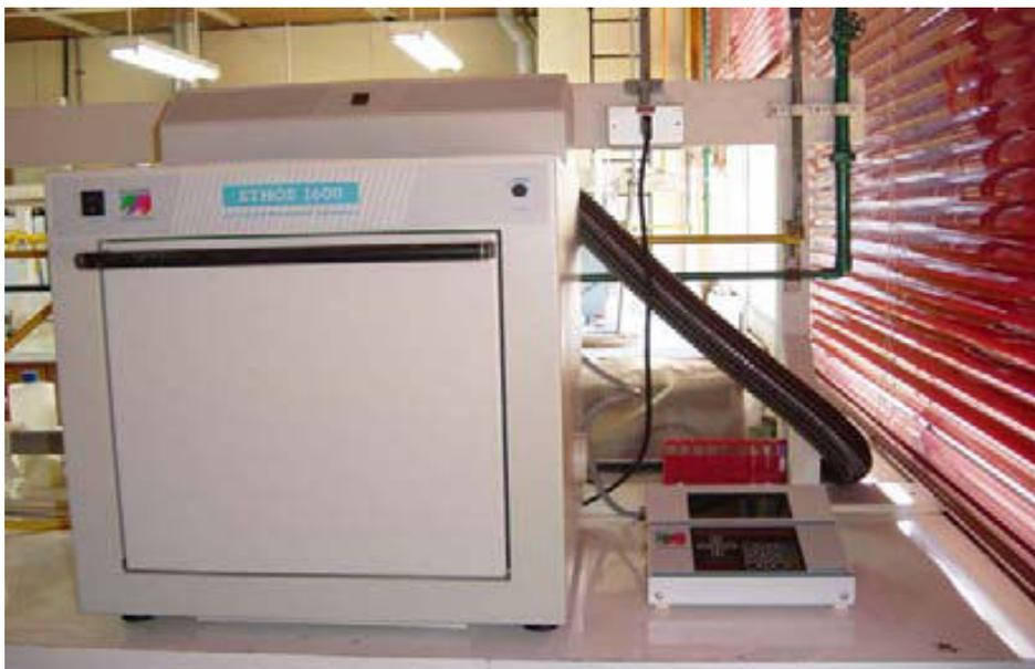
**Imagen 4.** Placa térmica, utilizada para evaporar a sequedad las muestras de Agua.
